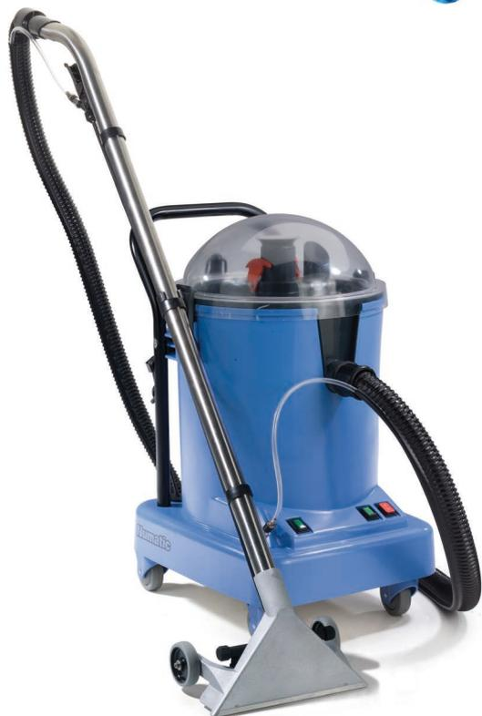
Injecteur extracteur avec système HI LO : pompe utilisable sur position HI (4 bars) pour sols textiles encrassés, ou LO (2 bars) sur surfaces peu encrassées ou nécessitant peu d'eau (siège...).
