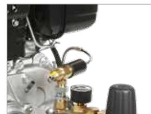
EQUIPÉE D'UN RÉDUCTEUR HYDRAULIQUE RÉDUISANT LA VITESSE ET LE BRUIT DU MOTEUR
