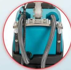
Tuyau de vidange situé à l'arrière de la machine, très facile d'accès.
