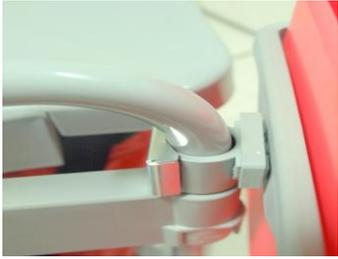
***Supports seaux de 6 litres sur axes pivotants pour laisser le libre accès à la presse.***
